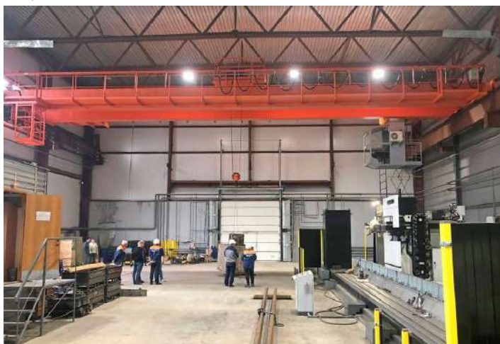
Кран мостовой опорный двухбалочный с электроприводом грузоподъемностью 5,0 тонн и длиной пролета 22,5 метров для предприятия в Муроме.
