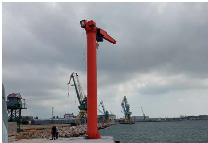
Кран консольный на колонне с электроприводом грузоподъемностью 10,0 тонн и высотой подъема 12,0 метров для предприятия в Севастополе.
