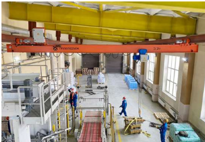
Кран мостовой подвесной с электроприводом грузоподъемностью 3,2 тонны и длиной пролета 10,6 метров для предприятия в Свердловской области.
