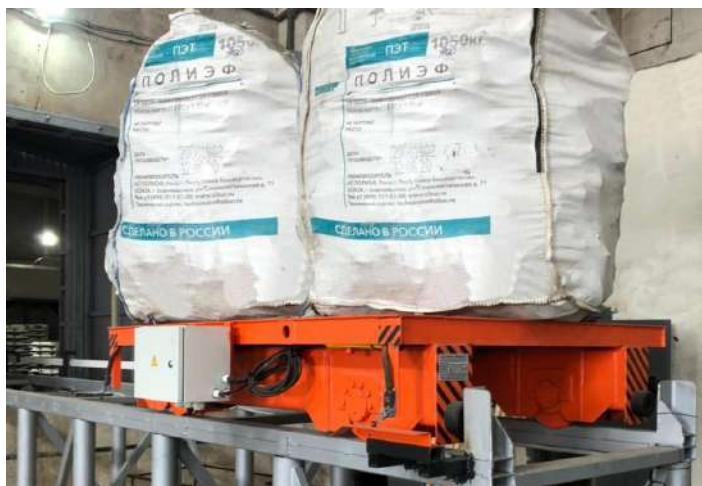
Тележка передаточная рельсовая с электроприводом на эстакаде грузоподъемностью 2,0 тонны для предприятия в Казани.
