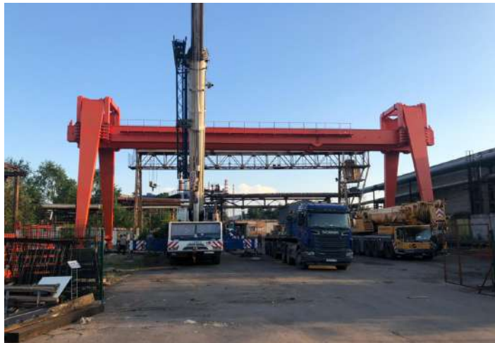
Кран козловой двухбалочный с электроприводом грузоподъемностью 32,0 тонны и длиной пролета 32,0 метра для предприятия в Санкт-Петербурге.
