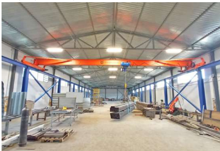
Кран мостовой опорный однобалочный с электроприводом грузоподъемностью 3,2 тонны и длиной пролета 16,5 метров в комплекте с подкрановой эстакадой для предприятия в Ленинградской области.
